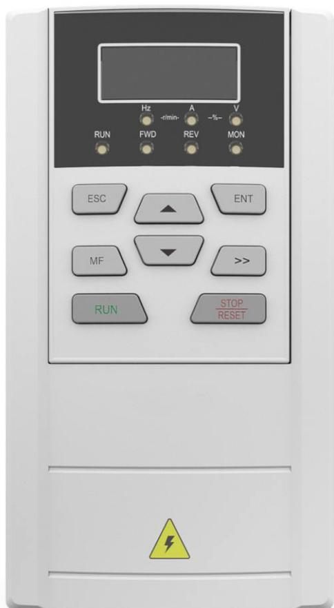
GV50/GV50C矢量控制通用变频器是利用空间矢量进行控制的变频器：支持三相交流异步机；支持恒定电压/频率比控制（V/F）和高性能矢量控制；内嵌两套电机完整参数，可实现无缝切换运行；支持键盘进行参数上传/下载操作；支持功能丰富的扩展卡：I/O扩展卡、通讯总线卡。其中GV50只支持无速度传感器矢量控制，GV50C既支持无速度传感器控制也支持有速度传感器矢量控制（FVC），板载自带一路ABZ光电编码器，可扩展ABZ、UVW、正余弦、旋转变压器等多种PG卡，实现高精度的闭环矢量控制。
