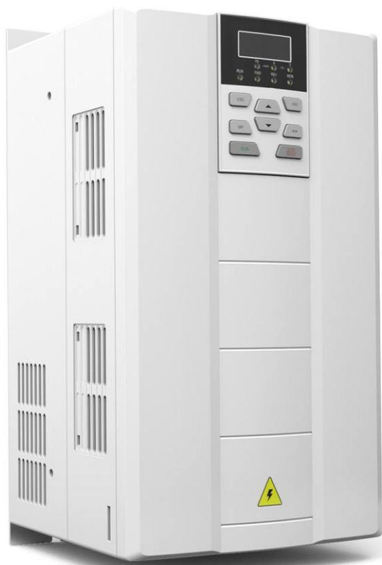
GV51风机水泵型变频器是在GV50矢量控制通用变频器的基础上，针对风机、水泵负载类型进行优化改进：风机水泵用降转矩输出曲线、带载转速跟踪启动、自动PID调节、丰富的I/O扩展卡满足风机水泵的外接仪表设备、空间体积优化，和GV50矢量控制通用变频器相比同样外型尺寸下输出电流大一档。
