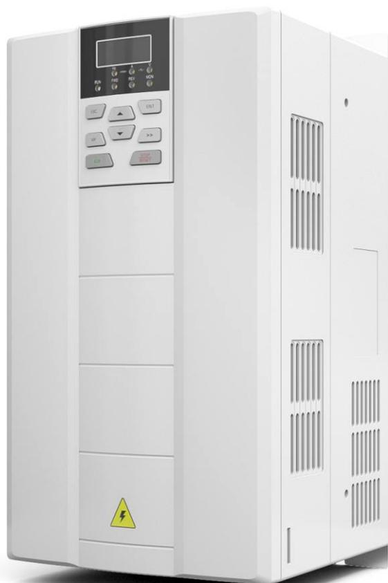
GV70/GV70C是耐尔公司针对永磁电机的运用开发的一款专用变频器，其中GV70只支持无速度传感器矢量控制，GV70C既支持无速度传感器控制也支持有速度传感器矢量控制（FVC）。板载自带一路ABZ光电编码器，可扩展ABZ、UVW、正余弦、旋转变压器等多种PG卡，实现高精度的闭环矢量控制。
